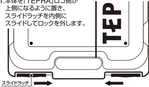
2. 「TEPRA」ロゴ側(フタ側)を上にして開閉してください。ご使用後はスライドラッチを外側にスライドし、必ずロックをしてください。
